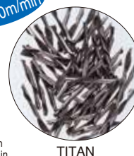
Material: TITAN V=75m/min. f=0.18mm/tooth S=1500min -1 F=1700mm/min.
